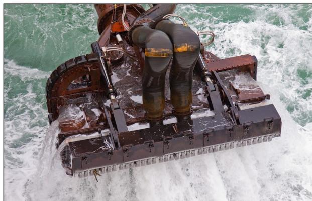
*Il rivestimenti totalmente ceramici, frequentemente applicati ai pistoni delle attrezzature di dragaggio spesso non sono sufficientemente resistenti agli urti. Oltre alla straordinaria protezione contro la corrosione, il Lunac 2+ duplex ha dimostrato di resistere alla maggior parte dei trucioli di pietra senza presentare microfratture.*
