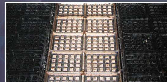
Onbehandelde (zwart) en Lunac 1 behandelde bakplaten na 800 uur.
